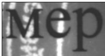
Рис. 1. Картина люминесценции в красной зоне спектра участка пересечения штрихов в последовательности: оттиск печати + штрихи текста
