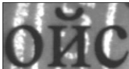
Рис. 2. Картина люминесценции в красной зоне спектра участка пересечения штрихов в последовательности: штрихи текста + оттиск печати
