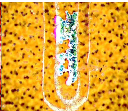
Рис. 4. Фрагмент рельефного знака на поддельной пластиковой карте, выполненный путем типирования
