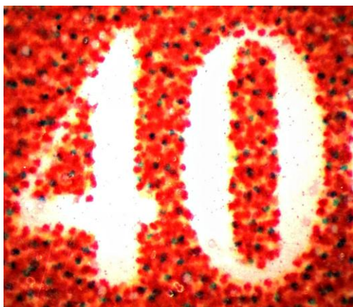
Рис. 3. Фоновое изображение на поддельной пластиковой карте, выполненное способом струйной печати
